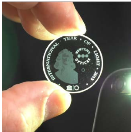
Le disque de quartz fondu mis au point par Peter Kazansky, peut contenir jusqu'à 360 To de données, soit plus de 25 BNF.
