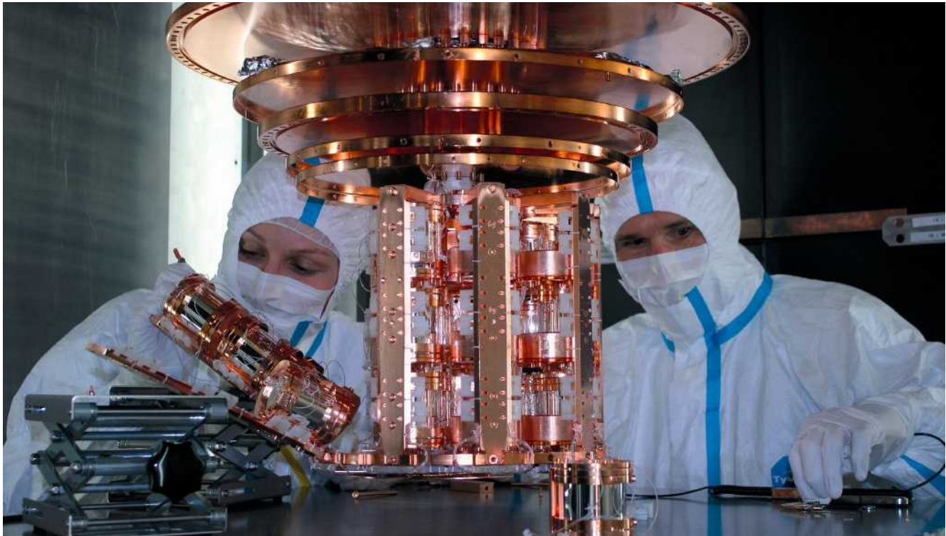
Le détecteur de l'expérience Cresst est enterré sous la chaîne des Apennins, en Italie, dans le laboratoire Gran Sasso. Il guette la matière noire, à l'abri des parasites de la radioactivité naturelle et des rayons cosmiques
