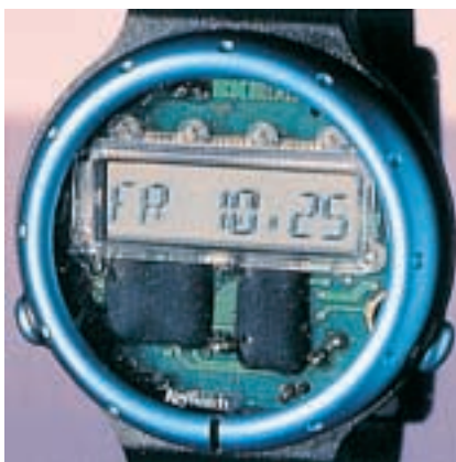
1. CETTE MONTRE cryptographique fabriquée par la Société autrichienne Skidata Computer , contient un émetteur-récepteur ainsi qu'un micro-ordinateur.
