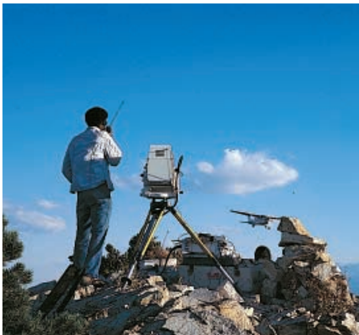
5. LES DÉFORMATIONS DE LA CROÛTE sont extrêmement lentes, mais des mesures soigneuses montrent les infimes mouvements du sol. La télémétrie par laser, entre les sommets des montagnes, détecte la contraction horizontale de la région depuis plus de dix ans. Les instruments modernes de positionnement par satellite (GPS) ont facilité la réalisation de relevés géodésiques précis.
