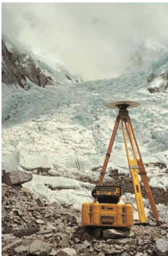
5. LES DÉFORMATIONS DE LA CROÛTE sont extrêmement lentes, mais des mesures soigneuses montrent les infimes mouvements du sol. La télémétrie par laser, entre les sommets des montagnes, détecte la contraction horizontale de la région depuis plus de dix ans. Les instruments modernes de positionnement par satellite (GPS) ont facilité la réalisation de relevés géodésiques précis.
