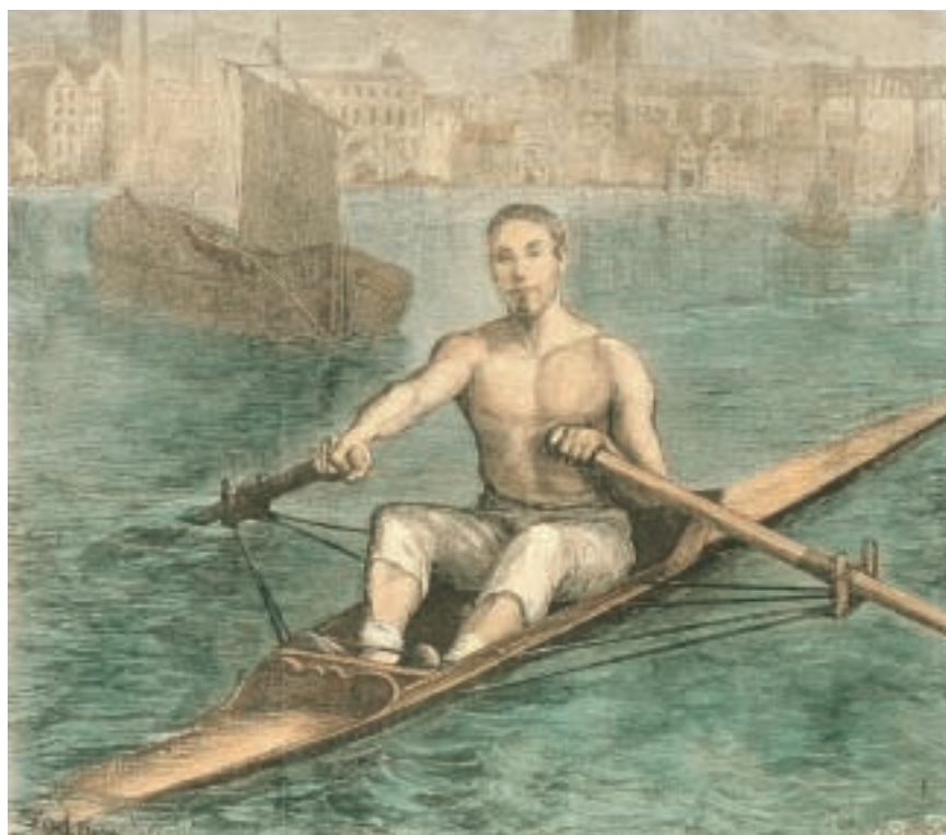
7. LES RAMEURS DU XIX e SIÈCLE , tel le champion Renforth, de Newcastle, ont adopté la technique du glissement dans les années 1850 et 1860. Ces rameurs utilisèrent initialement des pièces de cuir graissé cousues sur le fond de leur pantalon. Puis les sièges mécaniques à coulisses remplacèrent ce premier système.
