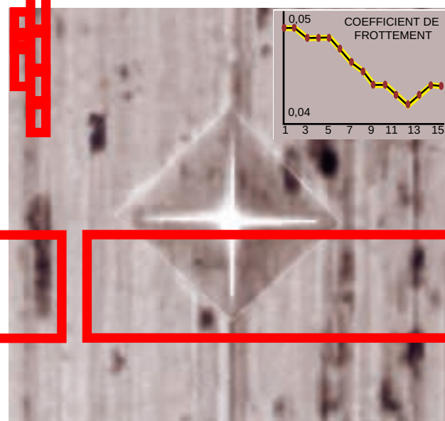
6. MICRO-INDENTATION pratiquée au centre d'une rayure d'un quasicristal icosaédrique par un indenteur en carbure de tungstène fritté. La forme de l'indentation indique que le matériau rayé est ductile, alors qu'il était initialement fragile. En haut, variation du coefficient de frottement lors de passages successifs d'un indenteur diamant.
