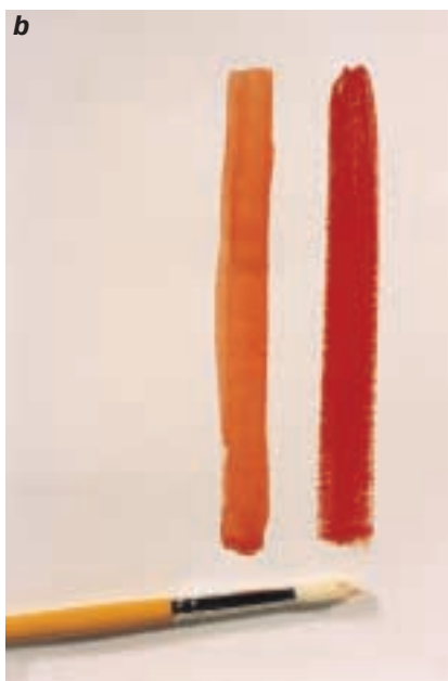
5. La fluidité de la peinture et la nature du support déterminent le type d'effet réalisé par les peintres et imposent le choix du pinceau. Les traces (a) et (b) ont été appliquées sur du papier, respectivement avec un pinceau de poils fins et un pinceau de poils durs. Ci-dessus, de même sur du Téflon (c et d). À gauche de chaque série, on a utilisé une aquarelle très fluide : à droite, de la peinture à l'huile en pâte.
