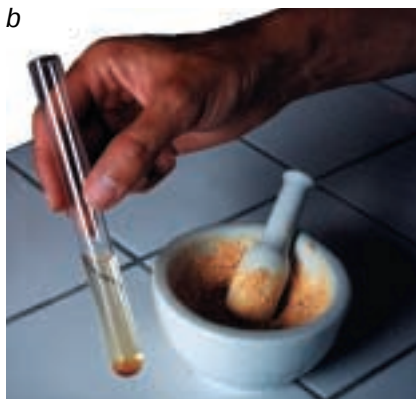
6. RECONSTITUTION D'UN PHYSAUTOTYPE selon le procédé de Niépce et Daguerre. Une résine de pin est fondue pendant quelques heures à 200 °C et versée dans un mortier (a) pour être broyée après refroidissement ; quelques milligrammes de la poudre obtenue sont ensuite dissous dans de l'alcool (b). On verse la solution jaune sur la plaque d'argent support (c). Après évaporation, la plaque est recouverte
