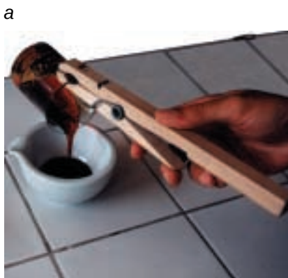
6. RECONSTITUTION D'UN PHYSAUTOTYPE selon le procédé de Niépce et Daguerre. Une résine de pin est fondue pendant quelques heures à 200 °C et versée dans un mortier (a) pour être broyée après refroidissement ; quelques milligrammes de la poudre obtenue sont ensuite dissous dans de l'alcool (b). On verse la solution jaune sur la plaque d'argent support (c). Après évaporation, la plaque est recouverte
