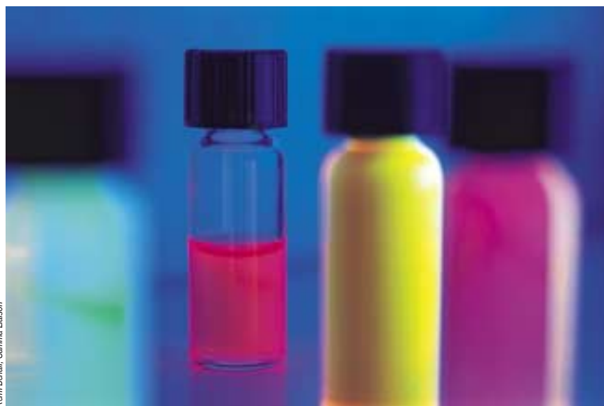
1. DES SUSPENSIONS DE PARTICULES NANOMÉTRIQUES du même matériau ont des couleurs différentes selon la taille de ces particules. Chacun des flacons présentés sur les photographies contient du sélénium de cadmium : seule la taille des grains varie. Chacun a une couleur différente, en lumière blanche (à droite) et en lumière ultraviolette (ci-dessus).
