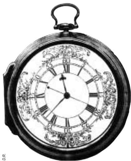
Le chronomètre de marine (H-4) de John Harrison.
