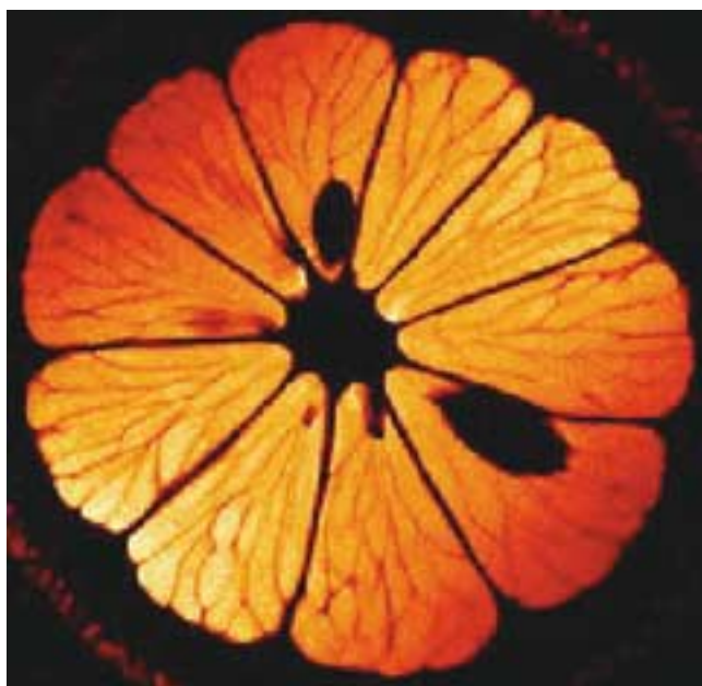
1. Image 2D d'une tranche d'orange observée sur un spectromètre Bruker RMN AVANCE 300 SWB .
