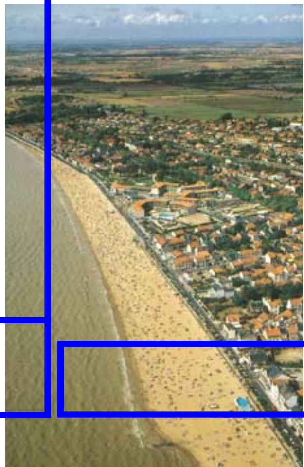
La plage de Châtelailon, en Charente-Maritime, a été reconstituée par l'apport de 300 000 mètres cubes de sable entre 1989 et 1991. La construction de digues et d'épis entreprise dès la fin du XIX e siècle n'avait pas empêché son érosion. Les courants littoraux ont partiellement déplacé vers le Sud (en bas) le sable apporté sur la zone centrale.
