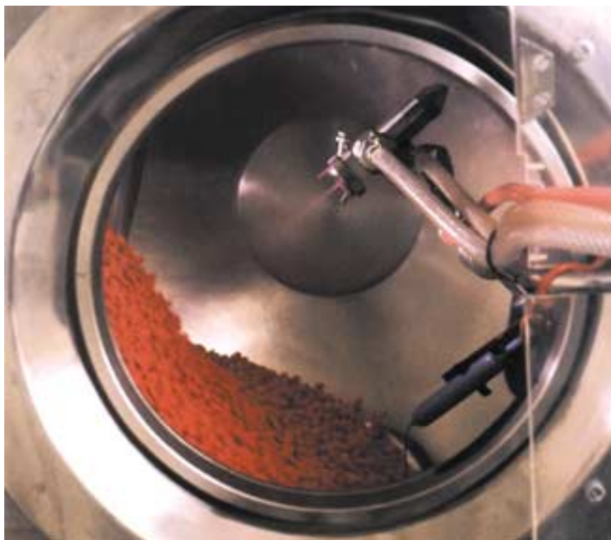
Pour revêtir les médicaments d'un film protecteur ou actif, on pulvérise une solution d'un polymère dans une turbine chauffée où les médicaments sont brassés.
