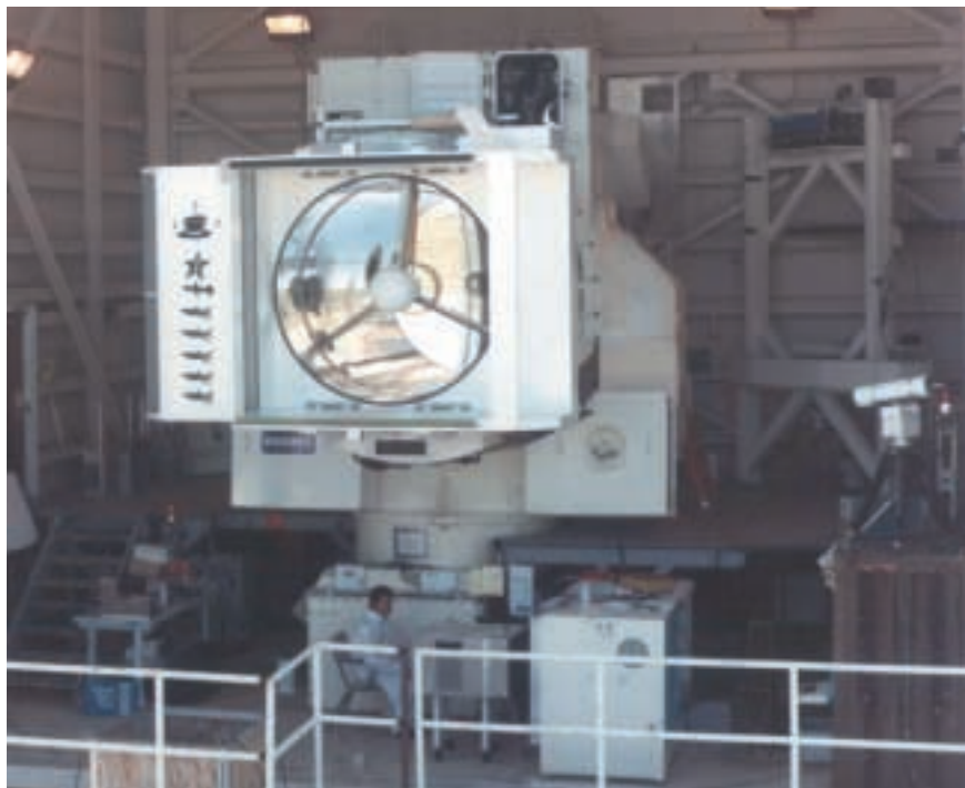
À l'aide d'un télescope de trois mètres de diamètre, les militaires pointent le laser MIRACL sur un satellite situé à plusieurs centaines de kilomètres d'altitude.
