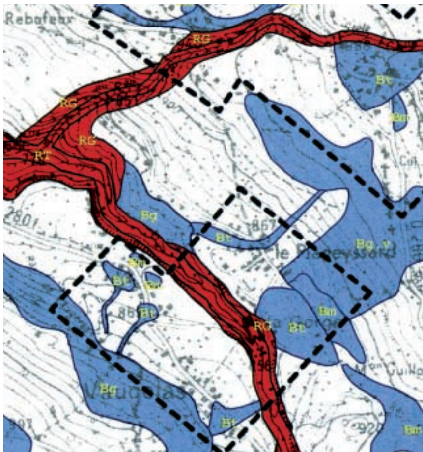
6. LE PLAN DE PRÉVENTION DES RISQUES (ici pour la commune de Laval, en Isère) a été décidé en 1995 en remplacement de tous les autres documents réglementant les risques naturels. Il distingue en rouge les zones non constructibles et en bleu les zones constructibles sous conditions (la nature des différents risques est indiquée par les lettres : M et m pour les marécages, T et t pour les crues des torrents, V et v pour le ruissellement sur les versants, G et g pour les glissements de terrain, P et p pour les chutes de pierres). Établi à partir de la connaissance des événements passés et prévisibles, ce plan devrait être réalisé pour 2 000 communes prioritaires d'ici à la fin du siècle.
