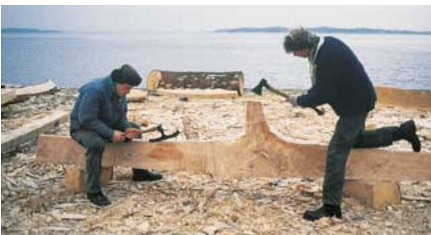
6. LES TECHNIQUES DE CONSTRUCTION NAVALE VIKING étaient illustrées sur la tapisserie de Bayeux ( en haut ), qui date du XI e siècle. Les archéologues ont expérimentalement cherché les opérations exactes qui étaient représentées. Des marques laissées sur les pièces de charpente d'origine montrent que l'outil essentiel était la hache à fer large plutôt que l'herminette ou la scie.
