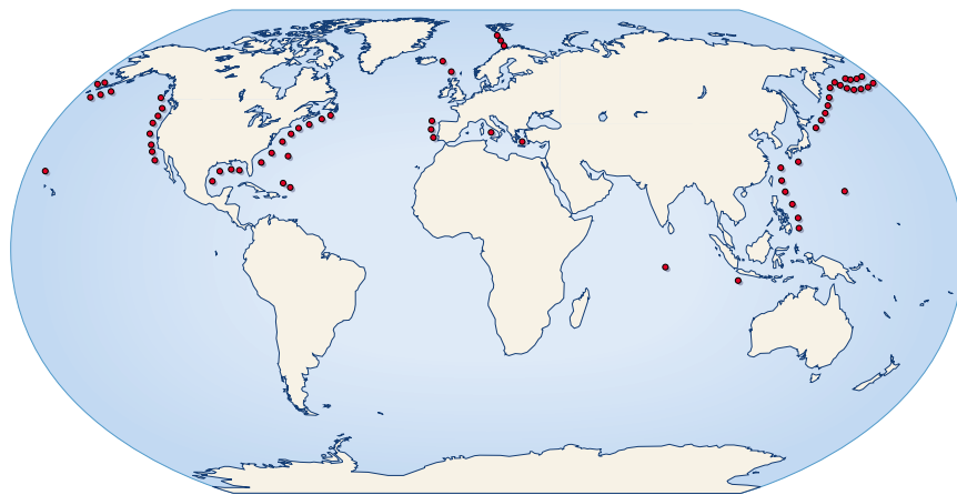
1. LE SYSTÈME AMÉRICAIN DE SURVEILLANCE SONORE (ou SOSUS) est composé de réseaux d'hydrophones déployés sur le fond de l'océan. Au début des années 1980, 66 réseaux étaient en fonctionnement (emplacements en rouge) ; après la fin de la guerre froide, leur nombre a diminué.
