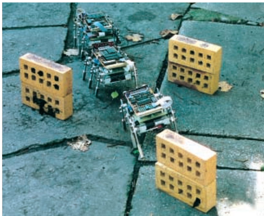
4. LES TROIS ROBOTS MARCHEURS coopèrent : dans un environnement couvert d'obstacles, le robot de tête met son sonar à la disposition des robots qui le suivent. Ces derniers économisent ainsi leurs ressources en énergie.
