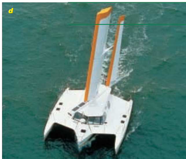
d sail. Cette vue d'avion de Zefyr permet de voir les panneaux solaires installés à l'avant de son aile. Ils alimentent en énergie l'ordinateur de bord et le petit moteur qui détermine l'orientation de la dérive.
