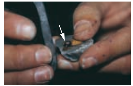
3. UNE LIME RECOURBÉE , dont l'acier riche en carbone est très dur, remplace avantageusement la marcassite dans un briquet à silex. Les étincelles embrasent un morceau d'amadou maintenu sur le silex (flèche).
