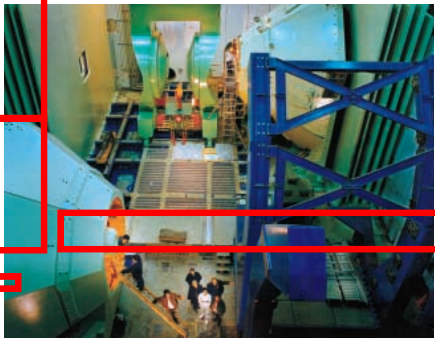
5. LE DÉTECTEUR PHENIX, ici avant son assemblage, comporte des «ailes» coniques conçues pour capturer les muons provenant d'un impact nucléaire. Certaines des plaques d'acier de ces ailes, expédiées de Saint-Petersbourg, sont parmi les plus grandes jamais fondues.
