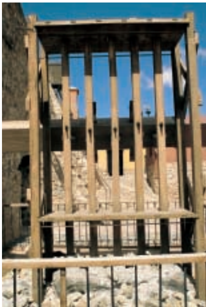
2. L'EAU UTILISÉE POUR LE CONCASSAGE coulait dans un aqueduc et actionnait les roues hydrauliques construites dans la maçonnerie (à gauche). L'axe de la roue était relié au concasseur (la poutre horizontale, sur la photographie de droite), dont les piliers faisaient subir au minerai réduit en poudre par une meule un traitement par le mercure pour récupérer l'argent.
