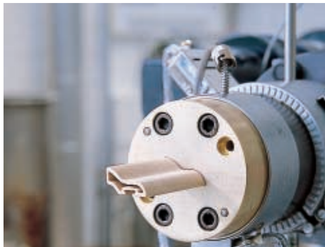
Extrusion d'un élément profilé pour le bâtiment (à gauche), à partir de granulés composés de résidus de scierie. Ces granulés permet-
