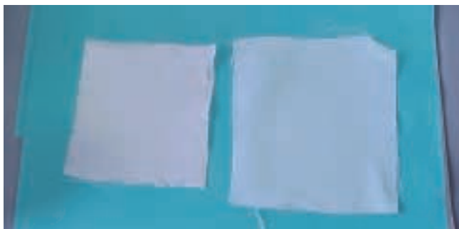
2. LES AZURANTS OPTIQUES sont l'un des composants de la lessive moderne. Ces molécules, qui contiennent du triazine et du stilbène, absorbent une partie du rayonnement ultraviolet ambiant et émettent un rayonnement visible dans le bleu. Sur la photo-
