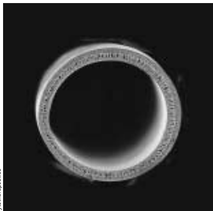
2. LES CAPSULES TUBULAIRES où on loge des cellules (ici, en coupe, une capsule vide) ont une enveloppe qui a la structure d'une mousse.
