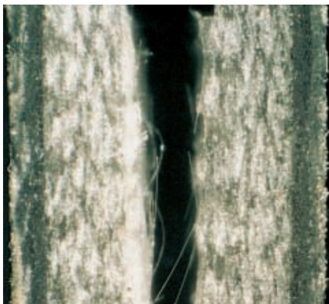
2. LES FISSURES se propagent dans les composites à fibres classiques, parce que les couches de textiles, faiblement liées, peuvent se détacher (à gauche). Les composites à renforts textiles tridi-
