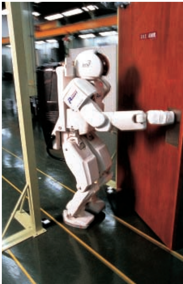
4. LE ROBOT P 3 est l'un des plus performants du monde. Il sait marcher, monter et descendre les escaliers, mais son autonomie n'est que de 25 minutes. Il a été construit par la Société Honda.
