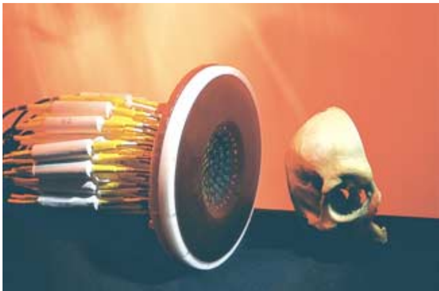
5. LA POROSITÉ DE LA BOÎTE CRÂNIENNE engendre une forte dissipation de l'énergie ultrasonore, d'où la grande difficulté de la focalisation des ultrasons sur les tumeurs du cerveau. Néanmoins, un miroir à retournement temporel muni d'un algorithme de correction de dissipation permet d'obtenir des taches focales très fines à l'intérieur du crâne.
