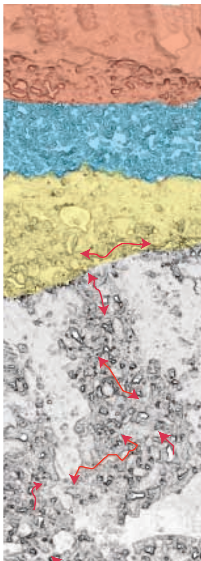
La coupe d'un échantillon du retable (0,2 millimètre de profondeur) fait apparaître différentes zones. En surface, le pigment rouge de mercure ; plus bas, une sous-couche de plomb (en bleu), puis une couche d'hydroxyde de fer déposée directement sur la roche (en jaune). Les flèches rouges montrent le trajet des fluides dans la partie dure de la roche.
