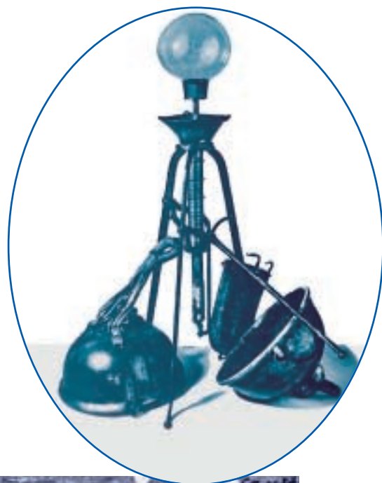
1. L'EXPÉRIENCE DES SPHÈRES DE MADGEBOURG, réalisée en 1654 par Otto von Guericke, mit en évidence «le vide». Après avoir appliqué les hémisphères l'une contre l'autre, von Guericke pompa l'air à l'intérieur. Deux attelages de huit chevaux de trait ne purent les séparer.
