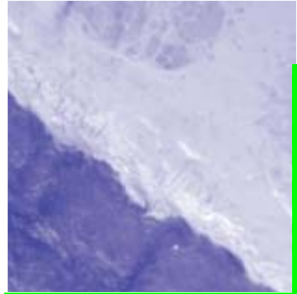
Le bioverre (en haut) favorise la formation d'une couche d'apatite (plus claire, au centre), cimentant provisoirement le bioverre avec l'os (en foncé).
