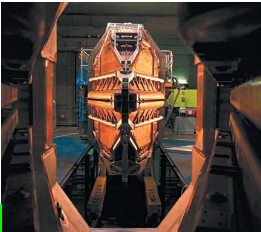
7. LES FAISCEAUX atteignent des énergies de 20 mégaelectronvolts dans l'accélérateur du GANIL, dont on voit ici l'une des cavités accélératrices.
