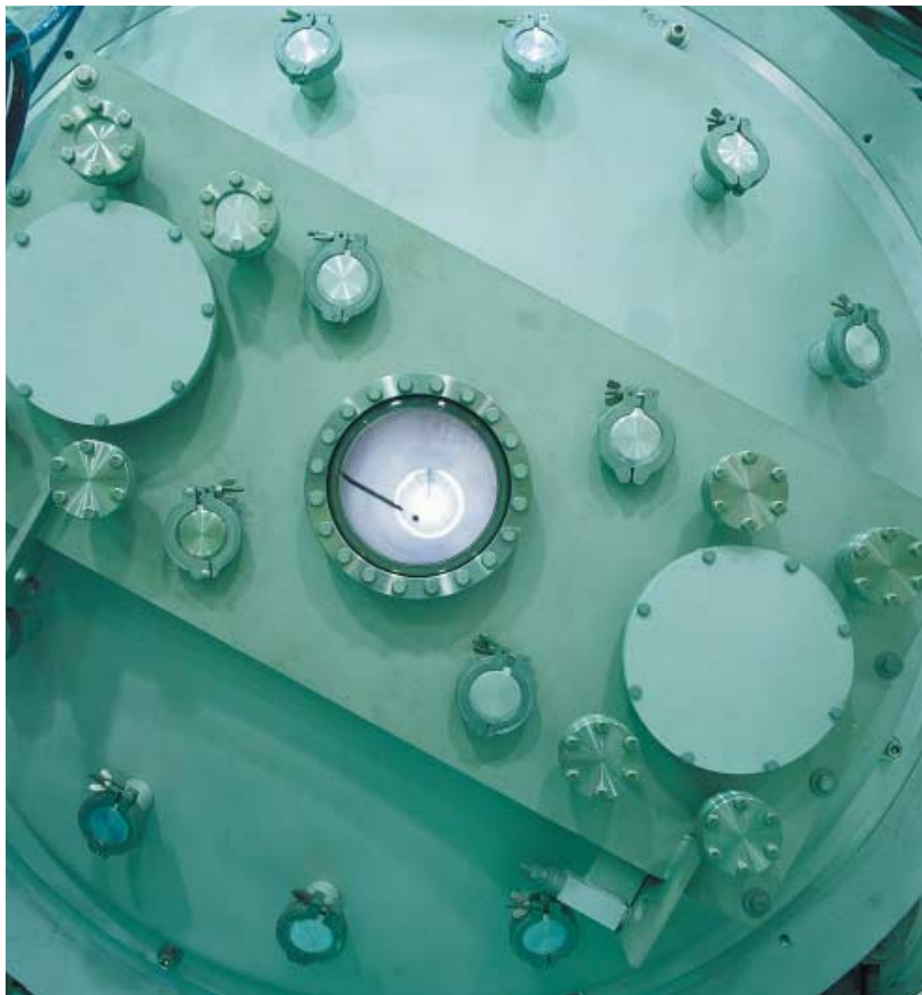
8. UN HUBLLOT DE VERRE de 15 centimètres de diamètre, placée dans l'axe du moteur VASIMR, permet de vérifier l'allumage du plasma.
