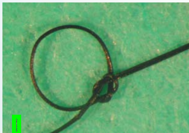
Nœud formé avec une fibre de nanotubes. Le rayon de la fibre mesure environ 15 micromètres.
