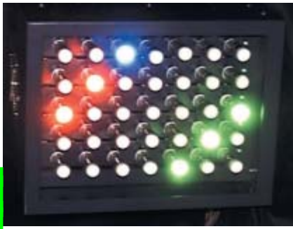
1. LES PREMIERS DISPOSITIFS ELECTRONIQUES qui utilisent des nanotubes sont des lampes à vide pour l'éclairage (à gauche) et un écran plat en couleurs (à droite). Ces produits exploitent la capacité des nanotubes d'émettre des électrons à des tensions relativement basses, ce qui se traduit par une économie d'énergie et une durée de vie supérieure.
