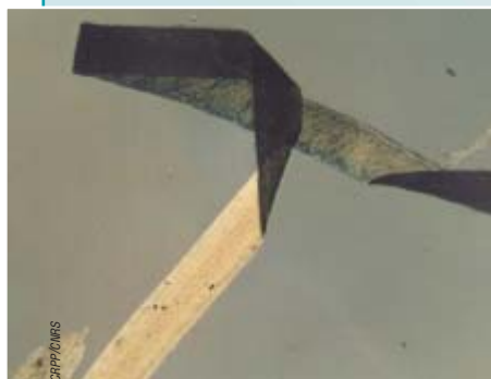
Un ruban de nanotubes de carbone a été plié. On l'a observé entre polariseurs et analyseurs optiques croisés. Les couleurs varient en fonction de l'orientation du ruban ; cette variation reflète une structure organisée : les nanotubes ont une orientation préférentielle au sein du ruban.
