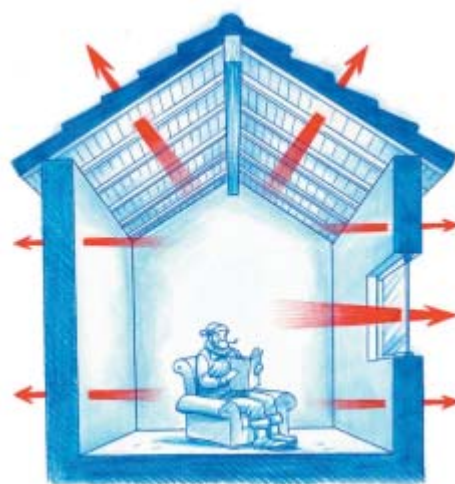
Les parois en contact avec l'extérieur, notamment les vitrages, sont une source importante de déperdition de chaleur.
