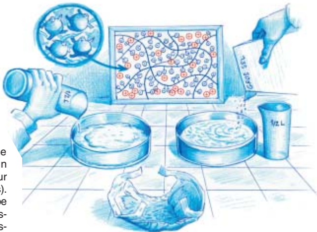
La masse de polyacide acrylique contenue dans une couche-culotte absorbe et y fixe jusqu'à un demi-litre d'eau. L'ajout de chlorure de sodium ou de tout autre sel en libère la plus grande partie.
