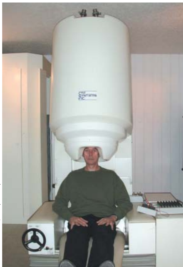
5. LE MAGNÉTOENCÉPHALOGRAPHE de l'Hôpital de la Pitié-Salpêtrière, à Paris. Le casque contient 151 capteurs supraconducteurs maintenus à très basse température grâce à l'hélium liquide contenu dans le réservoir supérieur. Cet instrument est équipé de 64 canaux d'enregistrements électroencéphalographiques, ce qui permet des mesures simultanées de l'activité électrique et l'activité magnétique du cerveau.
