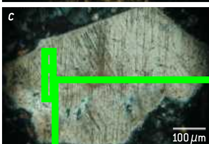
4. LES BRÈCHES OBSERVÉES AU MICROSCOPE révèlent l'effet de l'impact. Un grain de quartz choqué (c) est strié de multiples fissures laissées par les cisailages dus à de violentes ondes de choc. Des coupes (a et b) de deux brèches d'impact révèlent des fragments de diverses roches ainsi que du matériel du fond figé.
