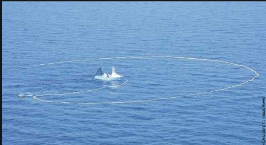
2. LA SENNE est un grand filet encerclant qui permet de capturer les poissons à la surface, en pleine eau. Ici, en Méditerranée, un senneur, le bateau équipé de ce filet.
