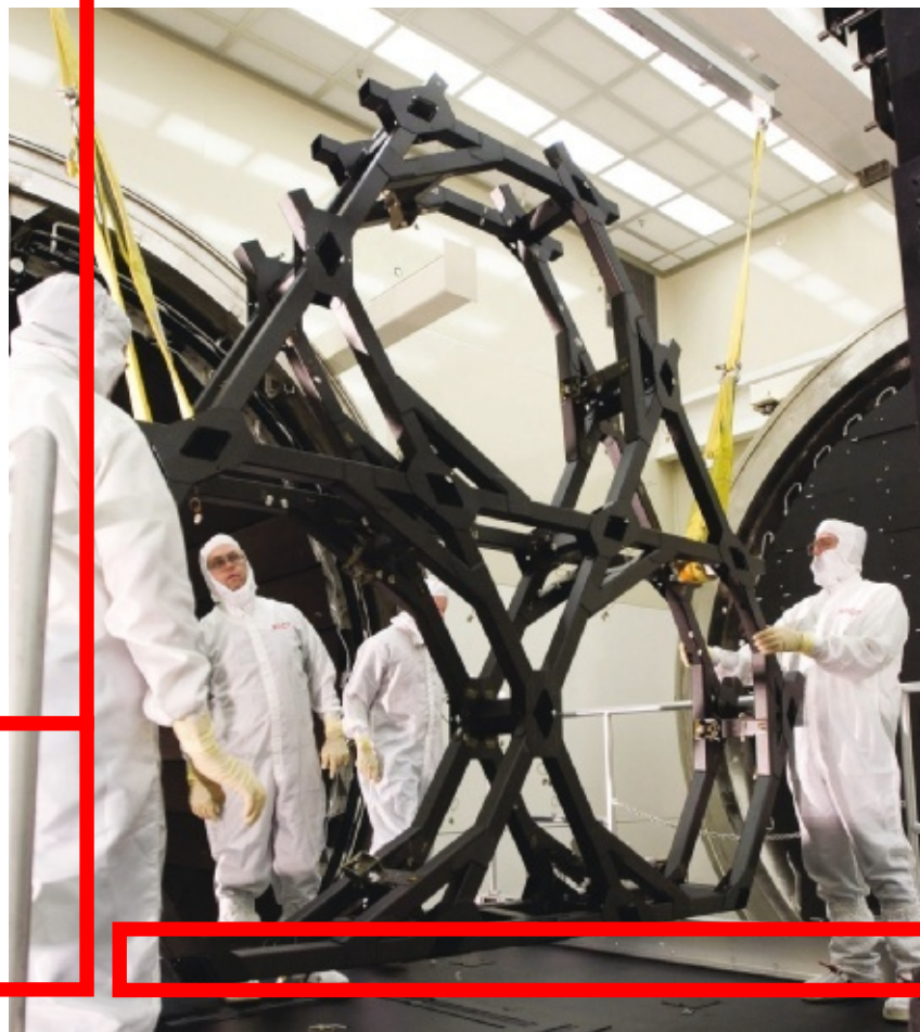
3. L'OSSATURE DU MIROIR PRIMAIRE, fabriquée avec des composites de graphite, du titane et un alliage de nickel et d'acier, est conçue pour ne pas se courber de plus de 32 nanomètres.
