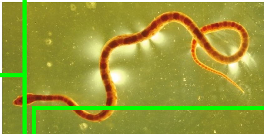
4. UN SERPENT DES BLÉS glissant sur de la gélatine photo-élastique illuminée par dessous et filmé entre des nitrés à polarisation croisée. Initialement, l'orientation des nitrés empêche la lumière polarisée de parvenir à la caméra, mais quand le serpent tourne, la rotation de la polarisation de la lumière, ce qui permet à la caméra de la détecter (les zones lumineuses sous le serpent). Cette technique visualise les points de contact du serpent avec le sol.
