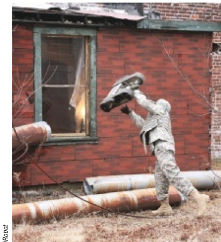
3. UN SOLDAT JETTE UN PACKBOT à travers une fenêtre avant de se mettre à l'abri. Les caméras vidéo du robot lui permettront d'explorer les lieux.
