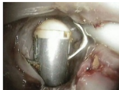
UNE GÉLULE HYBRIDE GUIDÉE par des électroaimants externes se déplace dans le côlon d'un cochon, en utilisant ses pattes pour ajuster sa position et repousser le tissu environnant.
