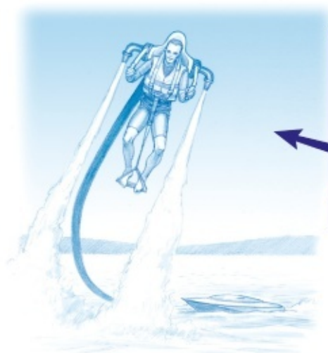
3. DANS LE DISPOSITIF JETLEV-FLYER , de l'eau est aspirée via un tuyau assez gros et expulsée par deux tuyères. La pompe et son carburant sont dans le bateau auxiliaire, ce qui évite de soulever une lourde charge.
