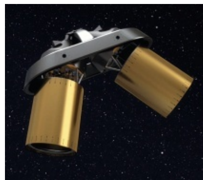
3. DES TÉLESCOPES focaliseront le faisceau laser (en haut) émis par le satellite placé à l'autre sommet du triangle. Chaque satellite comportera deux télescopes (en bas, dans leur enveloppe) et deux masses d'épreuve (à l'intérieur des parties grises, non visibles).
