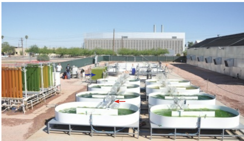
5. DE MULTIPLES SYSTÈMES DE CULTURE D'ALGUES sont étudiés, tels des bassins ouverts (en blanc au milieu ; la roue à aubes, pointée par une flèche rouge, crée une circulation d'eau) et des récipients fermés nommés photobioréacteurs. Ces derniers sont par exemple tubulaires (à gauche) ou à panneaux plats (flèche bleue). Les couleurs proviennent de souches algales variées ou de conditions de culture différentes appliquées à une même souche.
