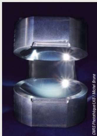
Une cavité formée de deux miroirs supraconducteurs (donc ultraréfléchissants) se faisant face permet de piéger des photons sur une longue durée.
