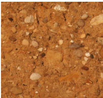
3. LA TERRE EST UN BÉTON D'ARGILE, comme le suggère le rapprochement de ces deux images. Ainsi, dans le béton de ciment en usage aujourd'hui ( en haut ), graviers et petites pierres sont liés par une matrice de ciment, tandis que dans le béton d'argile utilisé autrefois ( en bas ), ils le sont par une matrice d'argile.
