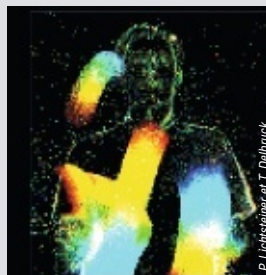
La caméra DVS n'enregistre que les parties changeantes d'une scène, en détectant les variations de luminosité sur chaque pixel. De telles variations se produisent par exemple lorsqu'un enfant bouge (à gauche). Sur l'image du jongleur (à droite), les mouvements de balle récents apparaissent en rouge et les plus anciens en bleu.
