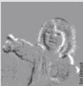
La caméra DVS n'enregistre que les parties changeantes d'une scène, en détectant les variations de luminosité sur chaque pixel. De telles variations se produisent par exemple lorsqu'un enfant bouge (à gauche). Sur l'image du jongleur (à droite), les mouvements de balle récents apparaissent en rouge et les plus anciens en bleu.
