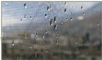
Les attrape-brouillards sont des filets qui capturent l'eau du brouillard, en suspension dans l'air. La forme de la structure de soutien peut être simple, comme à Atiquipa, au Pérou (à gauche), ou plus élaborée. Celle d'El Hierro (à droite) est étudiée pour empêcher le vent de décoller les gouttes qui se sont formées. L'eau ruisselle ensuite sur les filets, puis est collectée par divers systèmes.
